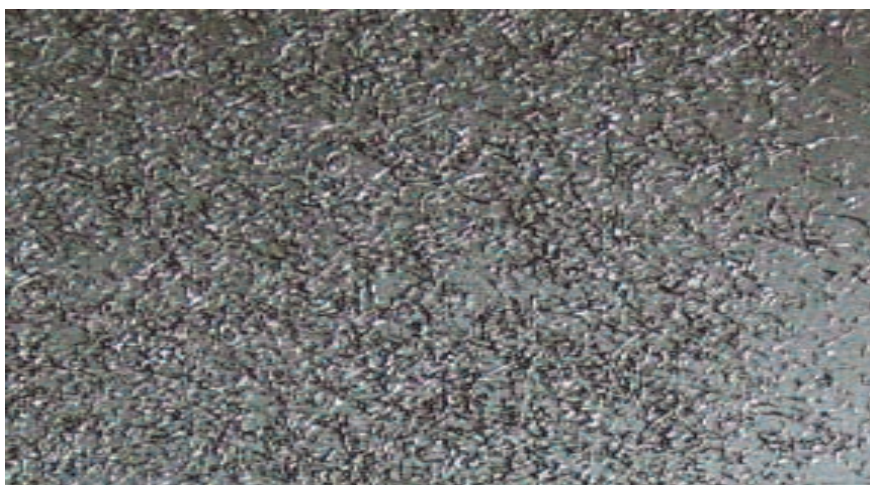
Figure 7. Paillettes de PEHD projetées – texture hétérogène
