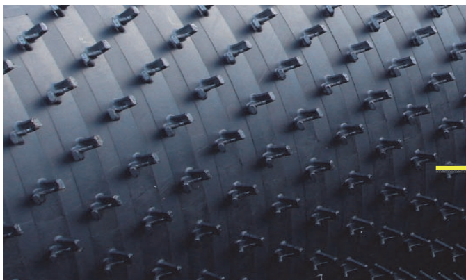
Figure 5. Structure à crampons, 19mm de haut
