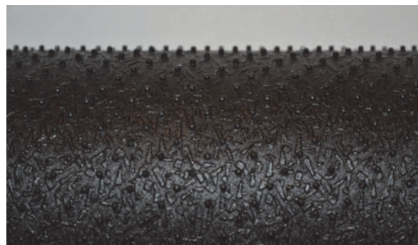
Figure 2. Micro-picots de 1,5 mm de haut.
