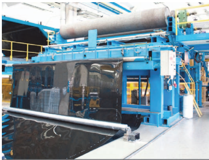
Figure 1. Fabrication par extrusion / calandrage
